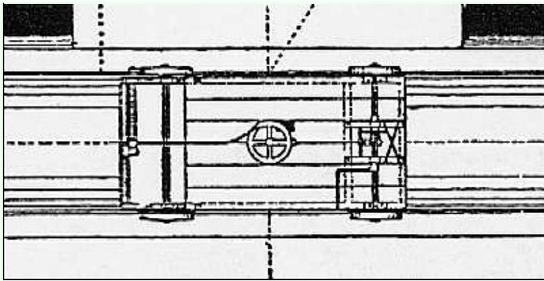
Die Spurweite der Draisine dürfte rund 1200 Millimeter betragen haben. In der Draufsicht ist links die Sitzbank dargestellt; mittig das „Drehrad“ und rechts der Hebelmechanismus.
